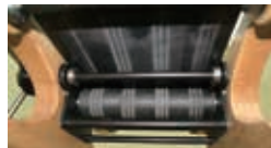
▲下滾輪齒紋處理 可增加印圖底板穩定性，讓底板在印刷過程中不易打滑空轉。
